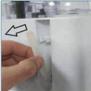
Nehmen Sie den Schlauch wie auf der Abbildung aus der Halterung.
