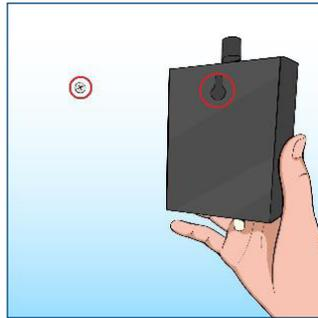
Befestigen Sie das Gehäuse mittels der Öffnung auf der Rückseite.
