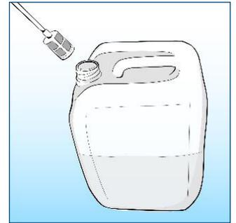
Verbinden Sie das Ende des Saugschlauches (Filter) mit dem Entkalkungsmittel.
